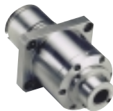
Mandrino MM 30 S REV Rpm max 6000 giri/1' Refrigerante interno Lubrificazione a grasso permanente Tenuta ad aria anteriore e posteriore Cuscinetti SNFA Ø 30 Attacco utensile ABS 40 o HSK 40
