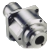
Mandrino MM 45 P REV Rpm max 6000 giri/1' Refrigerante interno Lubrificazione a grasso permanente Tenuta ad aria anteriore e posteriore Cuscinetti SNFA Ø 45 Attacco utensile ABS 50 o HSK 50
