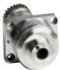
Mandrino MM 30 L REV Rpm max 6000 giri/1' Refrigerante interno Lubrificazione a grasso permanente Tenuta ad aria anteriore e posteriore Cuscinetti SNFA Ø 30 Attacco utensile ABS 40 o HSK 40
